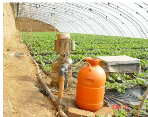
图 3 大棚应用的塑料低压施肥罐（立式，25 升）
